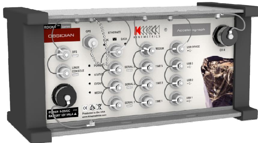
キネメトリックス(Kinemetrics)社製 オブシディアン(Obsidian)は、次世代Webベースの高性能地震計/収録装置です。高速サンプリング、演算機能、豊富な通信機能、時刻校正機能にGPSの他PTPを標準装備、遠隔でのメンテナンス機能を充実させるなど、多様化する地震観測に柔軟に対応することができます。
